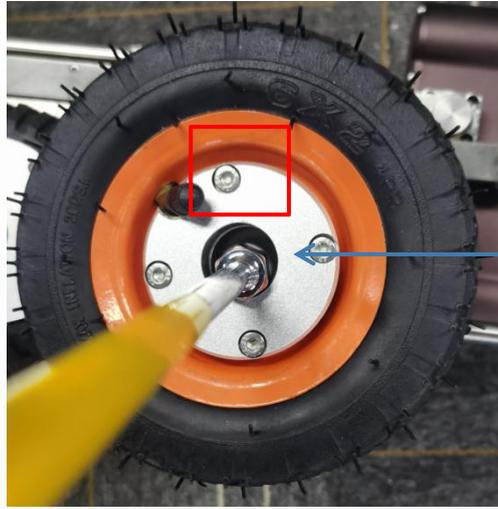
用 150mm 套筒工具套紧螺母，逆时针拆卸。
