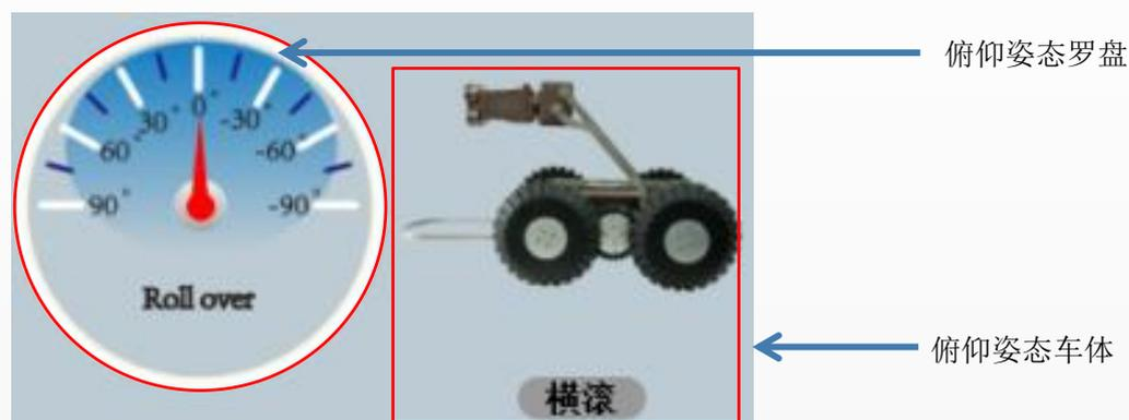
显示：左侧控制车体的俯仰姿态，当车体在运行时显示车体的实时横滚姿态，左姿态罗盘方向角度为左方向  $0^{\circ} \sim 90^{\circ}$  右方向是  $0^{\circ} \sim -90^{\circ}$ 。
