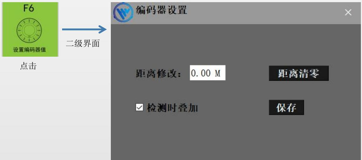
点击 F6 编码器设置可进入编码器二级界面,进入二级界面可单独对检测的工作的距离修改、和对检测距离的一键清零。
