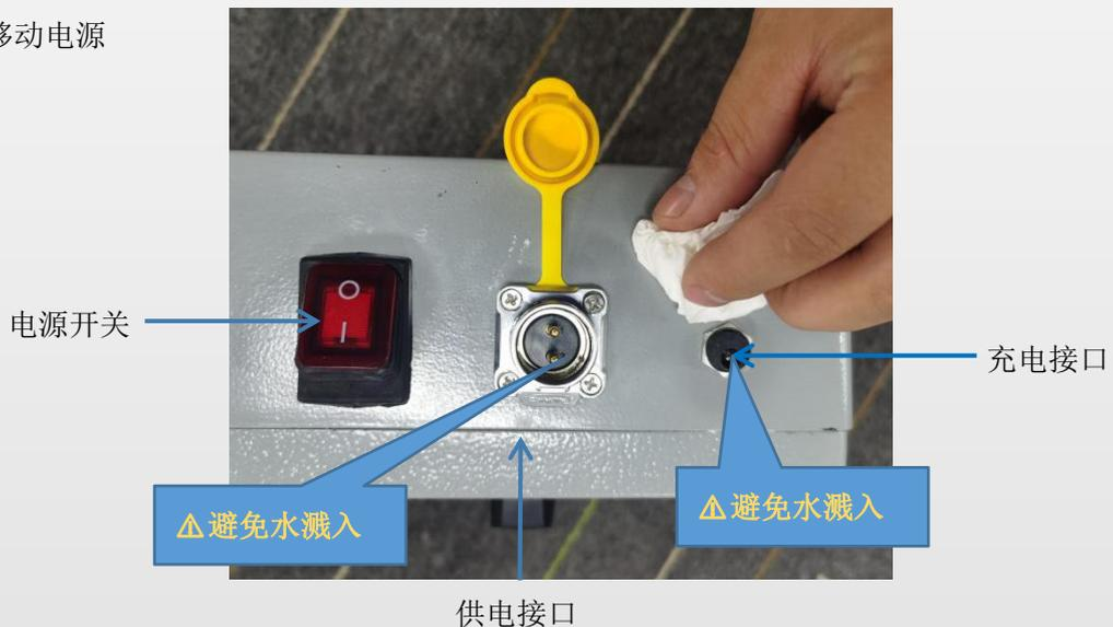
移动电源在清理时注意要用干抹布或干纸巾擦拭，不要用湿纸巾或湿抹布擦拭，同时要避免接口有水溅入，如有水溅入接口，应断电然后放置干燥处晾干，不要私自拆装或维修，一旦私自拆装保修条款立即失效，正确做法应联系公司或寄回公司维修。
